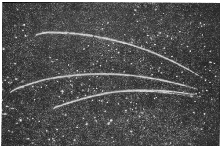
Рис. 10. Треки \alpha -частиц полония, искривленные магнитным полем напряженностью 43 000 эрстед (снимок получен П. Л. Капицей в 1924 году).
